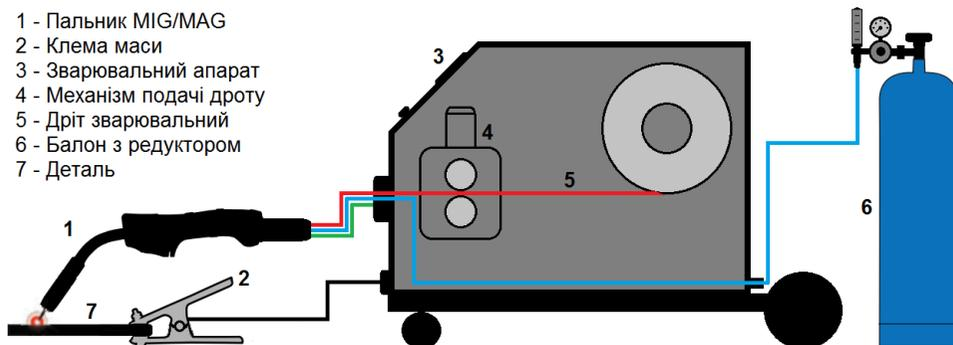
Підключіть газовий шланг, з однієї сторони до вхідного штуцера газового тракту та з іншої - до редуктора на газовому балоні.
