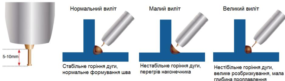
**Зварювання кутом вперед** застосовується для з'єднання тонкого металу, при цьому досягається менша глибина проплавлення, зварний шов більш широкий, зварювання відбувається з більшою швидкістю завдяки спеціальному розподіленню тепла.
