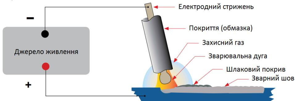
Покриття електроду виконує цілий ряд важливих функцій: утворення захисного газу навколо зони зварювання, забезпечення флюсуючими елементами та розкислювання розплавленого металу, створення захисного шлакового покриття над зварним швом при його охолодженні, покращення дугових характеристик, введення легуючих елементів у основний метал.
