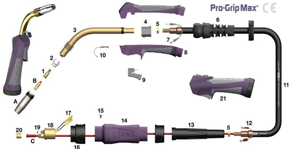
Зварювальний MIG/MAG пальник складається з трьох основних вузлів: центральний роз'єм KZ-2 для підключення до зварювального апарату; шланговий пакет, котрий містить у собі дроти керування, силовий кабель, направляючу спіраль електродного дроту та шланг для підведення газового захисту; робоча частина пальника. Зазвичай шланговий пакет для напівавтомату має довжину від 2,5 до 5 метрів.
