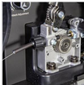
**Увімкніть апарат.** Переведіть вимикач живлення в положення «Вкл» («ON»). Перемикачем виду зварювання встановіть режим **MIG**. Зніміть сопло та наконечник з пальника. Натискаючи і утримуючи кнопку холостої протяжки зварювального дроту,
