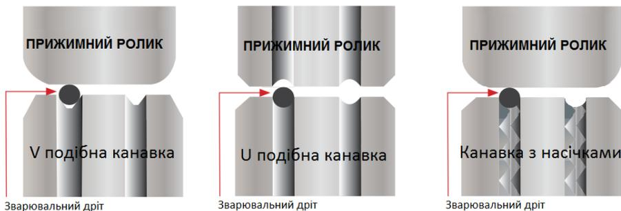
Ще один параметр підбору ролика – це кількість канавок, яких може бути одна або дві. Ролик з однією канавкою використовується для роботи одним діаметром дроту або ж може бути універсальним для двох суміжних діаметрів, маркування на такі ролики, як правило, наноситься на бічну сторону ролика. Ролики з двома канавками маркуються з обох боків в залежності від того, який діаметр дроту використовується. При встановленні ролика з двома канавками на механізм, слід пам'ятати, що робочою
